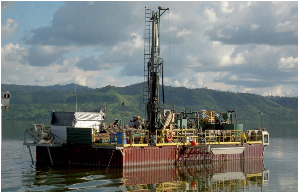
Abb. 4: Seebohrgerät GLAD800 auf dem Bosumtwi-See in Ghana. Die Barke besteht aus ausgeschäumten Containern und trägt eine modifizierte Seilkernbohranlage mit 800 m Gestängekapazität. (Foto: J. Kück, GFZ)
