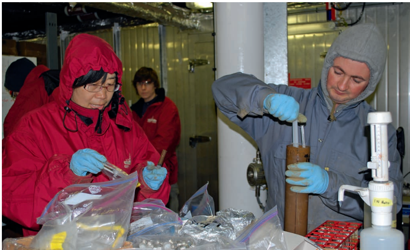
Abb. 3: Um zu vermeiden, dass die Organismen in den Bohrkernen durch Temperaturen geschädigt werden, die zu stark von der In-situ-Temperatur abweicht, muss die Beprobung der Bohrkerngegebenenfalls im Kühlraum stattfinden. (Foto: J. Kallmeyer, GFZ)
