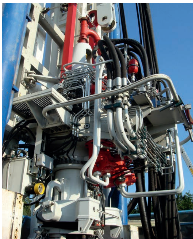
Abb. 1: Hydraulisch angetriebener Topdrive des Typs HV TD 350H am tiefsten Punkt des Masts im Hebwerk hängend. Eine Kombination von starren Hydraulikleitungen und flexiblen Hochdruckschläuchen versorgen die hydraulischen Antriebsmotore (rote Bauteile). Die blauen Bauteile am Bildrand stellen die Hebwerkzylinder dar. (Foto: A. Jurczyk, GFZ)
