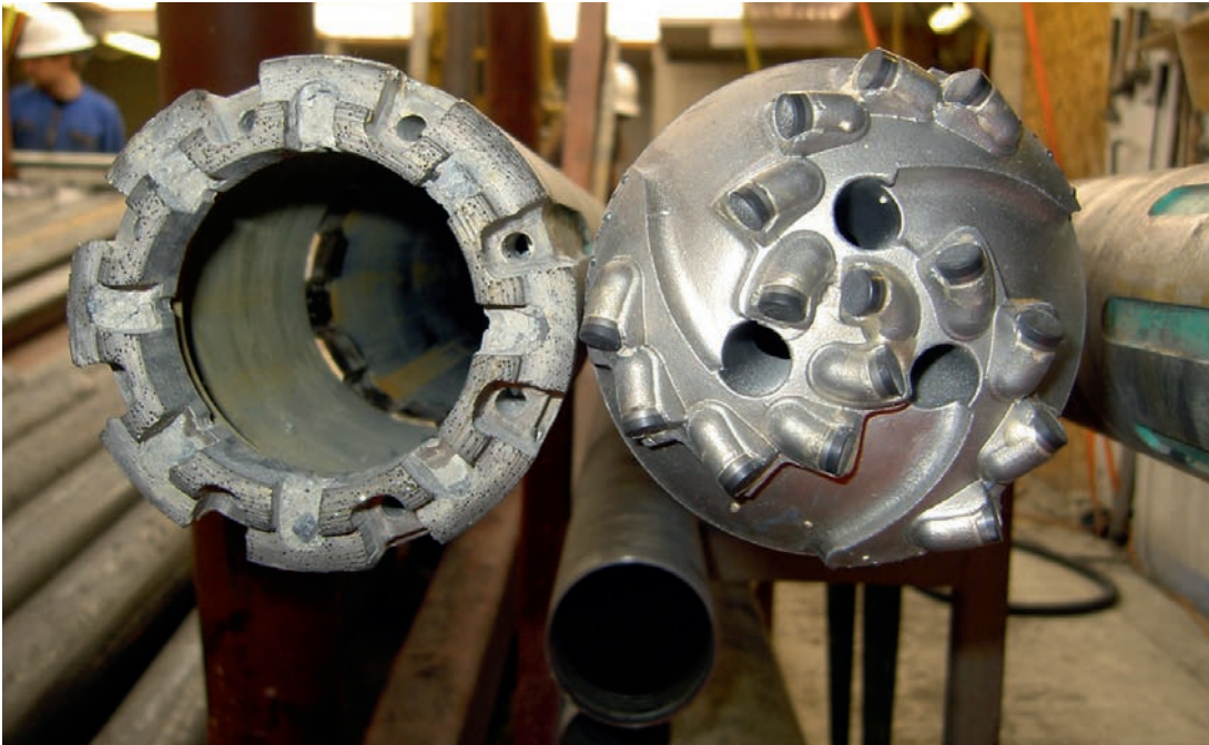
Abb. 6: Diamant-Bohrkrone (links) und Vollbohrmeißel im HQ-Größe (96 mm Bohrloch) (Foto: J. Kück, GFZ)
