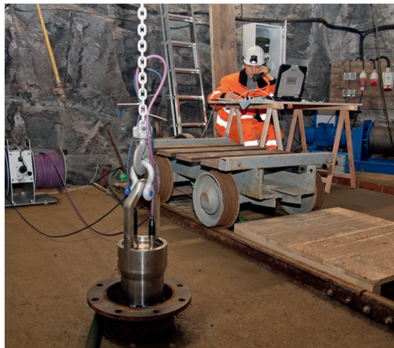
Abb. 5: Blick in die Bohrkammer des GFZ-Untertage-Labors Reiche Zeche während des Einfahrens der SPWD-Sonde in die Bohrung B3 (Foto: A. Jurczyk, GFZ)
