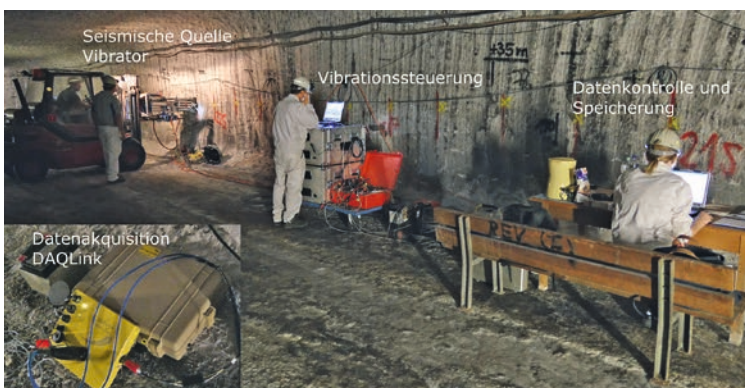
Abb. 6: Untertägiger seismischer Messeinsatz im Bergwerk. Die programmgesteuerte seismische Quelle überträgt elastische Wellen in den Untergrund, welche von Sensoren empfangen und über ein Datenakquisitionssystem (DAQLINK) registriert werden. (Fotos: R. Giese, GFZ)
