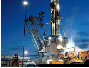
GFZ-Bohranlage InnovaRig beim Abteufen einer Geothermie-Bohrung nahe Dürrnhaar, Bayern
