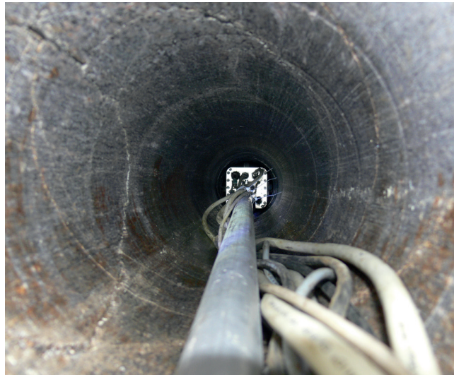
Laborprototyp der SPWD-Sonde (unten) und Sonde bei Messungen in einem Bohrloch (oben) des GFZ-UntertageLabors im Lehr- und Forschungsbergwerk „Reiche Zeche“
