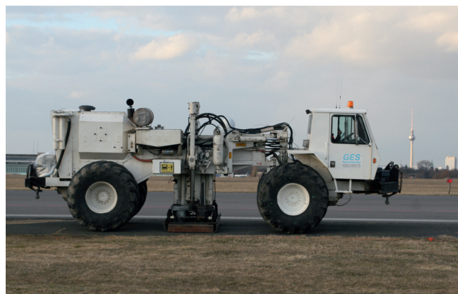
Vibrator-LKW bei den seismischen Testmessungen auf dem Tempelhofer Feld, Berlin
