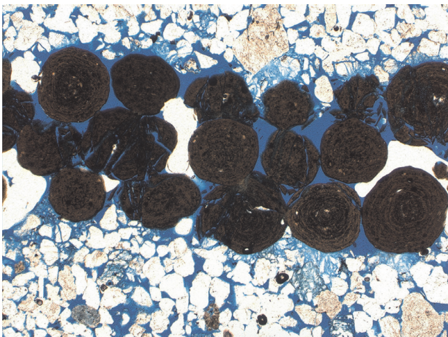
Abb. 6: Die Einlagerung von Proppants gewährleistet, dass sich erzeugte Risse im Gestein („Fracs“) nicht wieder schließen, und dass der Gasfluss zum Bohrloch aufrechterhalten wird (Abb. aus Reinicke et al., 2011).
