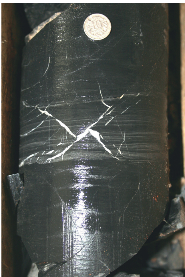
Abb. 9: Kluftsysteme in Gas Shales können das hydraulische Aufbrechen erleichtern.
