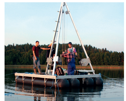
Mithilfe von Flößen taufen Wissenschaftler Bohrungen in Binnenseen ab. Die Bohrkerne von Seesedimenten sind ein präzises Klima-Archiv.
