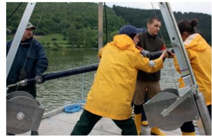
*Entnahme eines Sedimentkerns auf der Bohrplattform am Meerfelder Maar (Foto: A. Brauer, GFZ)*
