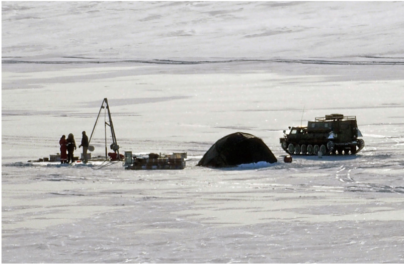
Abb. 3: Bohrcamp an der Küste der Lapteewsee. In Kooperation zwischen dem Alfred-Wegener-Institut (AWI), dem Deutschen GeoForschungsZentrum (GFZ) und russischen Kollegen zum Beispiel aus Novosibirsk und Jakutsk wurden im April 2017 subaquatische Permafrost-sedimente gewonnen, um daran u.a. mikrobiologische Studien durchzuführen. Bild: Jan Axel Kitte / GFZ
