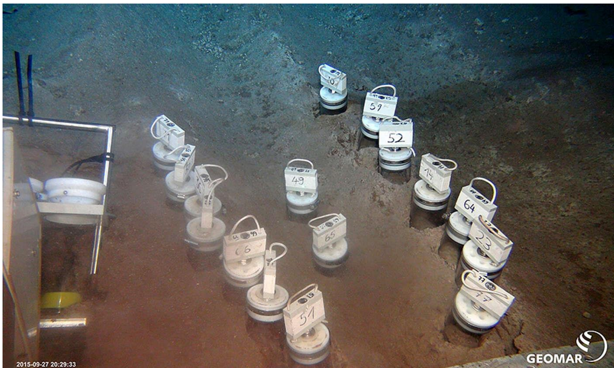
Abb. 1: Probenahme mit einem ferngesteuerten Fahrzeug (ROV) an einer der experimentellen Störungsstrecken, die 1989 mit einem Schiffsschlepppflug angelegt wurden. (Foto: GEOMAR, ROV Kiel 6000)
