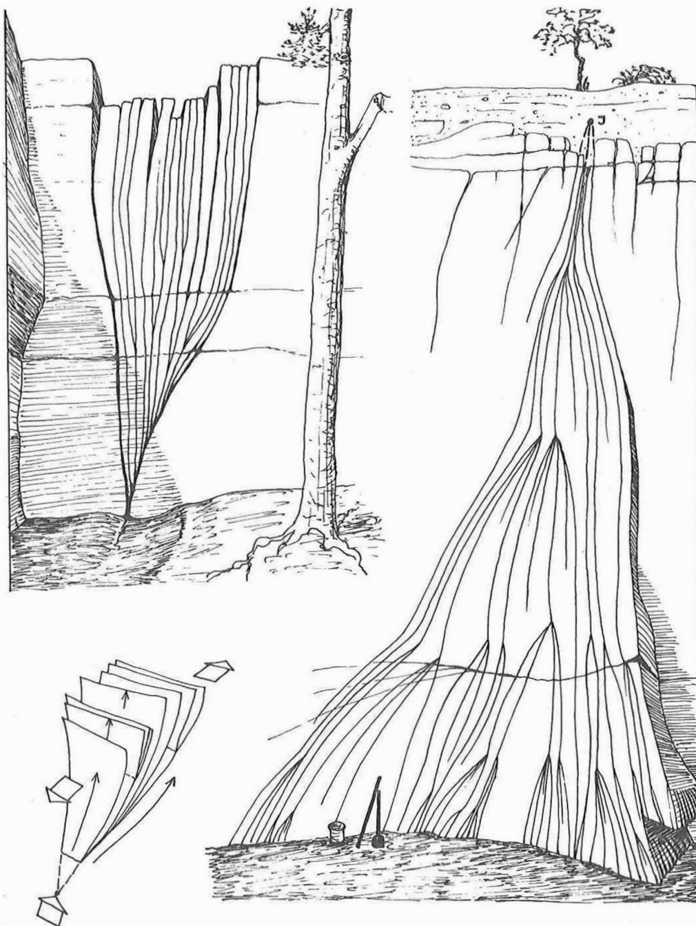
Abb. 5. Schema der Bruchausbreitung und Bruchformen bei E_{pot} \gg G
