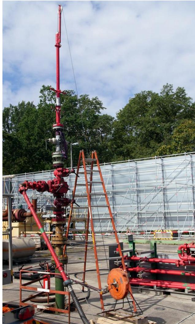
Abb. 4: Anschlussaufbauten für hydraulische Tests an der Tiefbohrung BH14 auf dem Sondenplatz C des Berliner Erdgasspeichers. (Foto: Daniel Acksel/GFZ)
