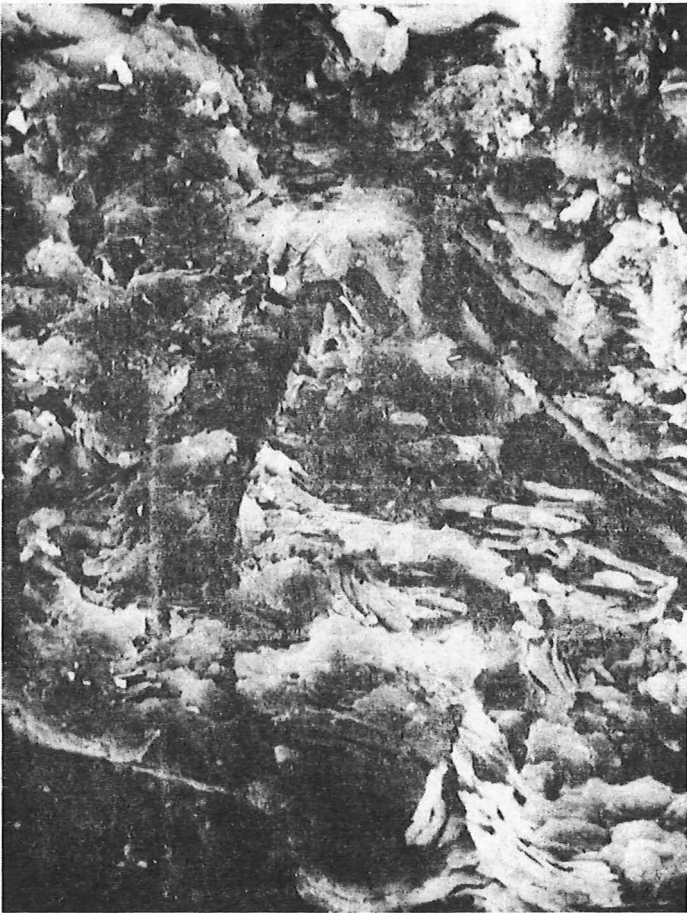
Abb. 45: Biotitgneis, Rupturelle Deformation von sk_2 -Glimmern durch D 3. s_3 ist als intragranularer Ri (steil zur flach nach rechts unten einfallenden sk_2 ) verfolgbar. Probe 482, Schtzenberg sdlich Zethau; Vergrerung 1 200fach.
