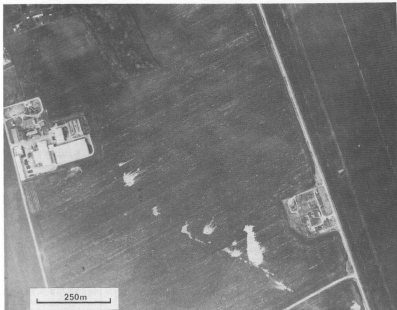
Abb. 1: Das Luftbild vom Havariegebiet zeigt in eindrucksvoller Weise die lineare Aufreihung der Ethenausbrüche zwischen der betroffenen Sonde (rechts unten) und einer Lagerhalle südlich des Ortes Teutschenthal (Flughöhe: 1200 m, Brennweite: 152 mm, Aufnahme: 3. April 1988, 16.15 Uhr)
