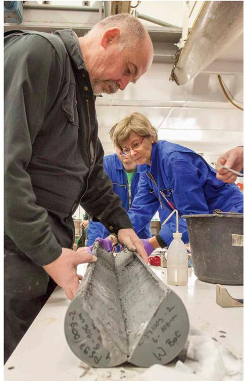
Abb. 2: Öffnen eines Sedimentkerns an Bord des Forschungsschiffs Polarstern (Foto: T. Ronge, AWI)
