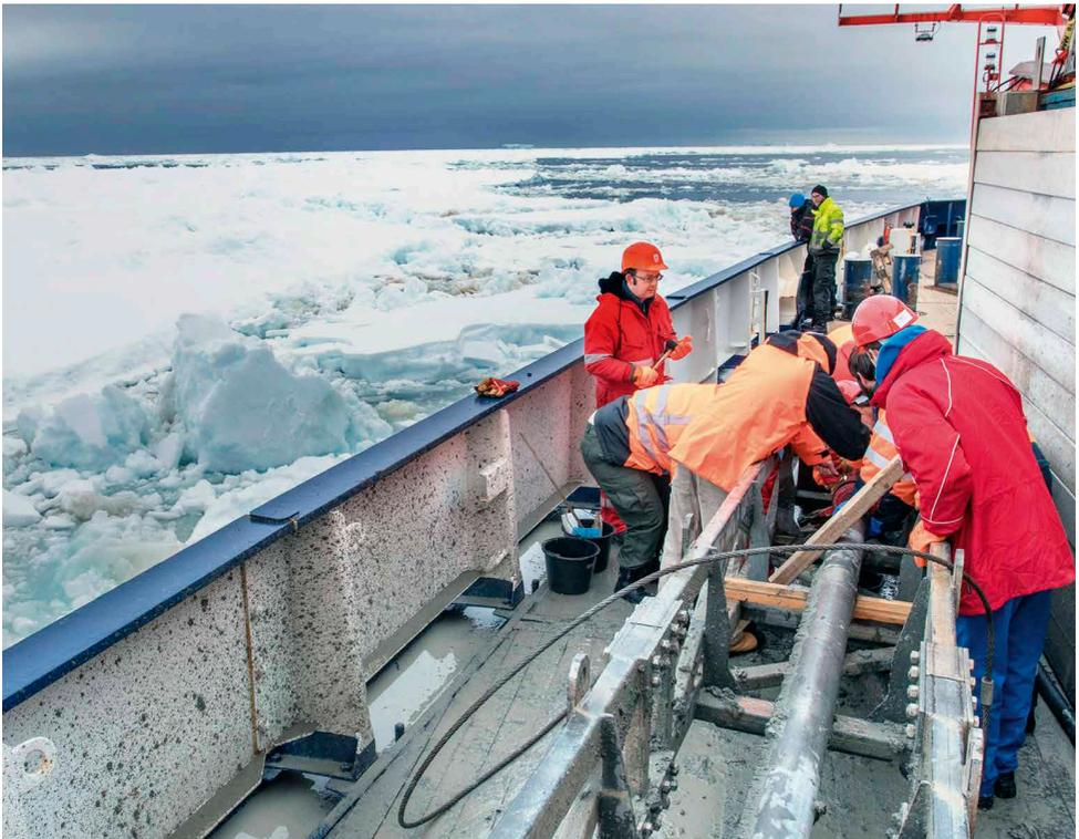
Arbeitsdeck der FS Polarstern: Nach erfolgreichem Kolbenloteinsatz wird der Sedimentkern aus dem Lot geborgen und in handliche, 1 m lange Sektionen geschnitten (Foto: T. Ronge, AWI).
