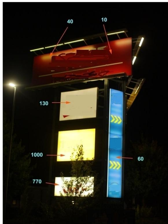
Abbildung 30: Leuchtpylon mit gemessenen Leuchtdichten (in  $\text{cd/m}^2$ ). Durch LED werden hohe Leuchtdichten erreicht, eine Begrenzung auf  $100 \text{ cd/m}^2$  erscheint sinnvoll. (Bildquelle und Messungen: Wiedergabe mit freundlicher Genehmigung von A. Hänel).
