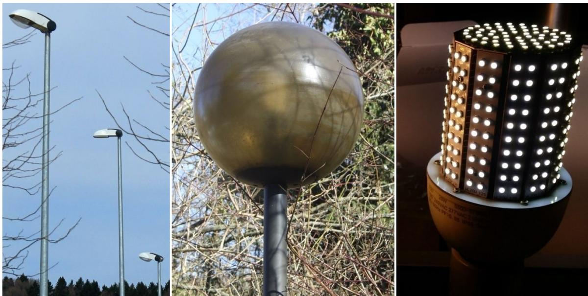
Abbildung 36: Links: voll abgeschirmte (Mitte) und zwei teilweise abgeschirmte Leuchten (oben und unten), Mitte: eine nicht abgeschirmte Leuchte, rechts: “Maiskolben”-LED-Lampen als Retrofit-Leuchtmittel (Bildquelle: Wiedergabe mit freundlicher Genehmigung von Hänel)
