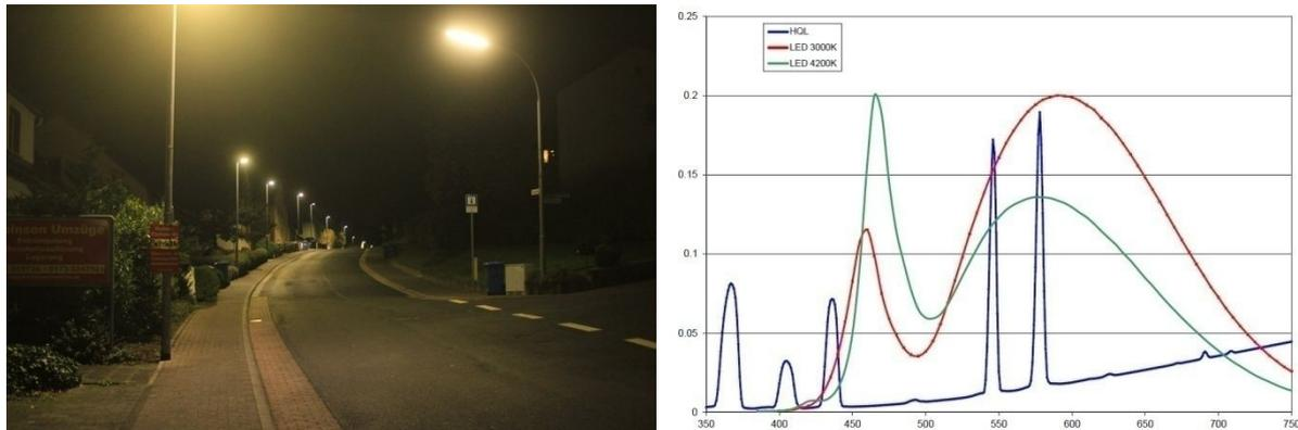
Abbildung 25: (links): Im Vordergrund Leuchtstoffröhren mit einer Farbtemperatur von 4000 K, im Hintergrund LED-Leuchten mit der gleichen Farbtemperatur, deshalb sind Farbunterschiede kaum festzustellen (Foto: A. Hänel). (rechts): Relative spektrale Verläufe von Quecksilberdampf- und LED mit Farbtemperaturen von 3000 K und 4000 K (Daten von DMSP)
