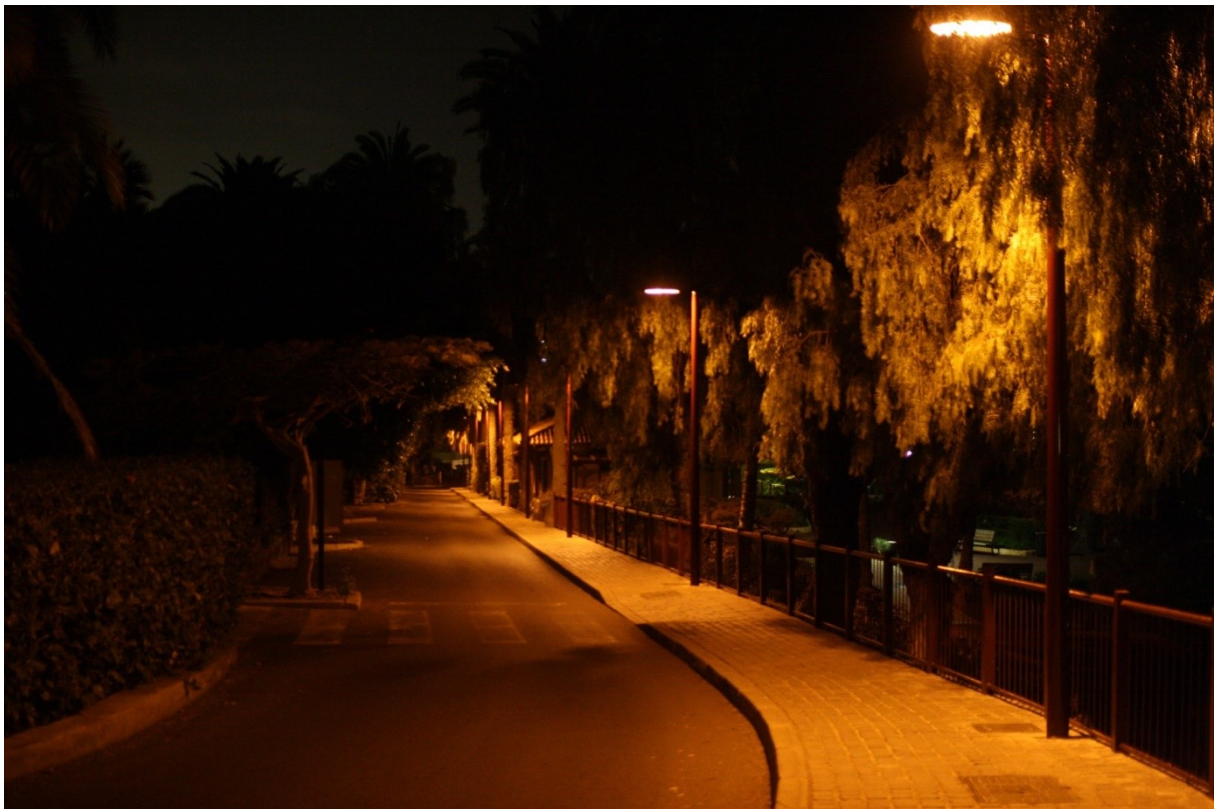
Abbildung 6: Beispiel für Leuchten mit Lichtstärkeklasse G6 (Beschränkung der Abstrahlungsgeometrie in Winkeln von 10-20° unterhalb der Horizontalen). Foto: A. Hänel.
