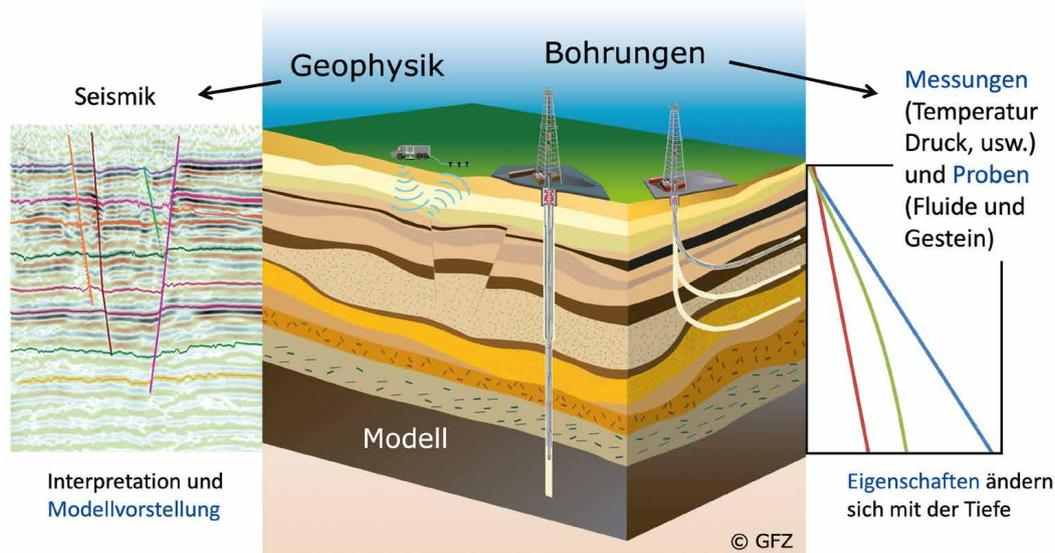
**Abb. 3:** Basierend auf verschiedenen Beobachtungstechnologien wird das geologische Modell des Untersuchungsgebiets erstellt. Direkte Messmethoden finden Anwendung in Bohrungen im Untergrund, aus denen Gesteins- und Fluidproben gewonnen werden (Genderjahn et al., 2021). Diese werden mit den Ergebnissen der indirekten Messmethoden, z. B. der Seismik (Lüth et al., 2021), kombiniert und interpretiert.
