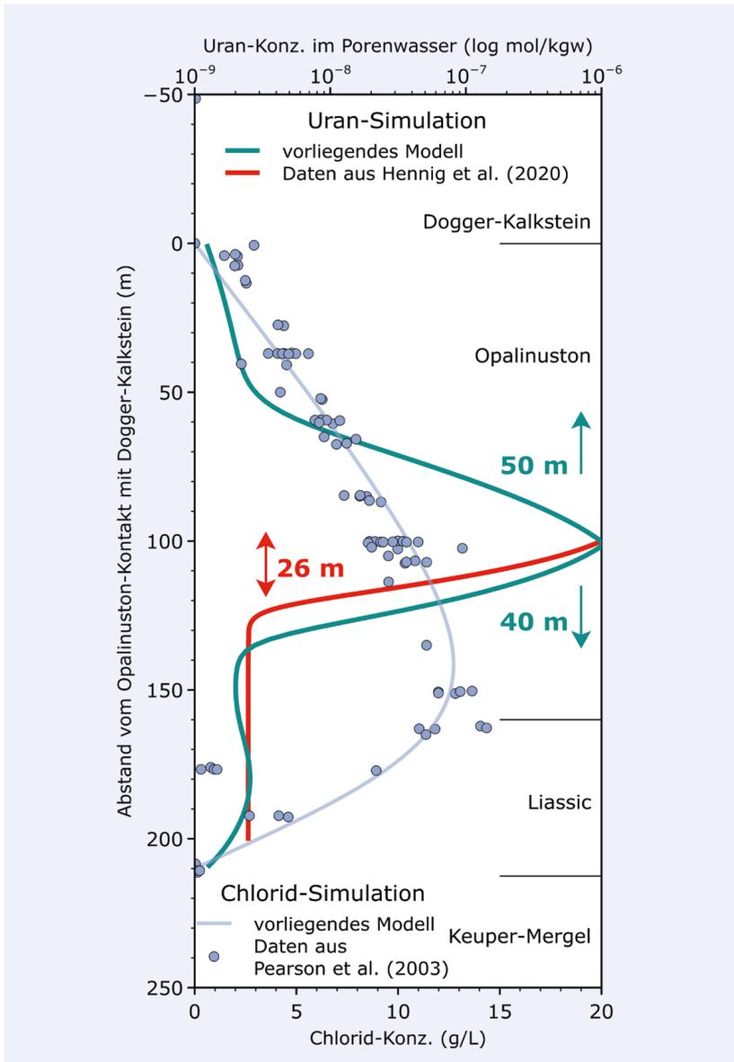
Abb. 4: Ergebnis der Modellierung der Radionuklidmigration im Opalinuston. Geochemische Gradienten im System des Mont Terri (blaue Punkte) verstärken die Uranmigration (grüne Linie) durch die Formation hindurch im Vergleich zur Simulation eines homogenen Systems (rote Linie). Das berechnete Chloridprofil (blaue Linie) stimmt mit Messdaten aus Bohrlochanalysen überein.
