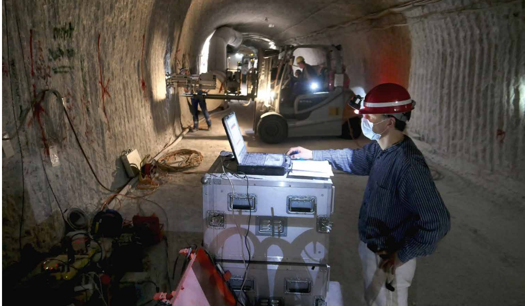
Abb. 1: Untertägige seismische Messungen bringen Licht ins Dunkel. In einem Salzbergwerk wurden so durch das GFZ Umfelderkundungen durchgeführt. Vordergrund: Digitale Datenaufzeichnung; Hintergrund: Anregung seismischer Signale durch eine auf einen Gabelstapler montierte Vibrationsquelle (Foto: R. Giese, GFZ)
