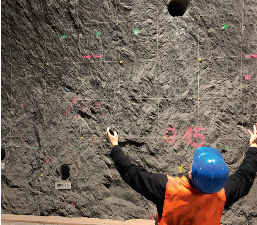
Abb. 1: Aufschlussfenster der Hauptstörungszone im Untertagelabor Mont Terri in der Schweiz. Diese tektonische Störungszone verläuft durch die tonige Fazies des Opalinustons. Sie ist gekennzeichnet durch ein dichtes Netzwerk von Scherflächen und Aufschiebungen und bietet die Möglichkeit, mechanische und hydraulische Eigenschaften vor Ort oder mit Bohrkernen im Labor zu untersuchen. (Foto: A. Schleicher, GFZ)
