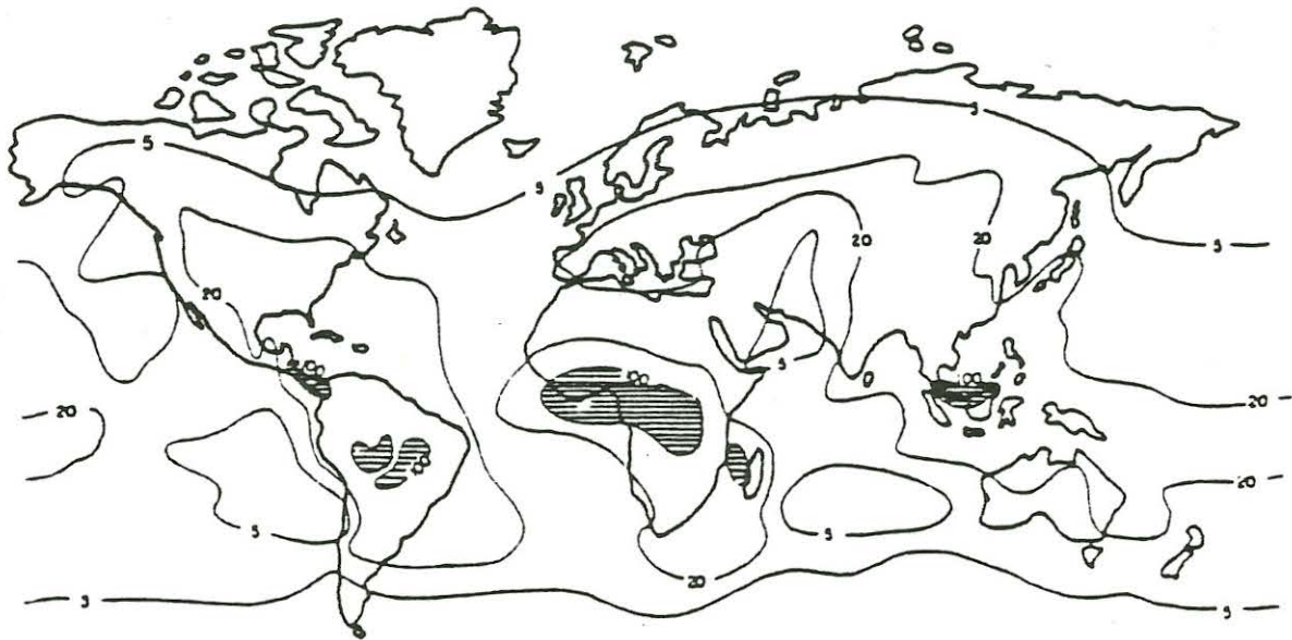
Fig. 3: Isolinien der mittleren jährlichen Anzahl der Tage mit Gewitter. Schraffiert sind die Gebiete mit über 100 Tagen Gewitter im Jahr. (Keller, Frischknecht, 1966)
