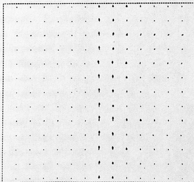
Abb.9 ; Äquivalentstromsystem im Aluminiumblech, das in der rechten Bildhälfte liegt. Die Pfeile geben wie in Abb.8 Richtung und Betrag induzierter Ströme zwischen benachbarten Gitterpunkten an, oben Realteil, unten Imaginärteil.
