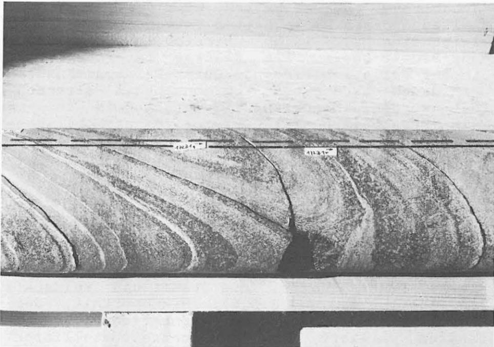
Abb. B.5.5: Falte in einem Gneis mit hornblende- und/oder biotitreichen Bändern (Kernstücke 172B1q+r, 811 m).
