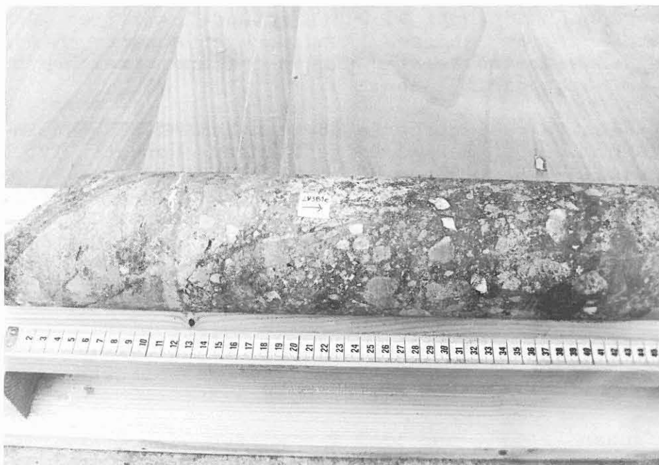
Abb. B.3.3: Verfestigte Störungsbreccie mit Nebengesteinsfragmenten (Kernstück 283B1e, 1351.4 m).
