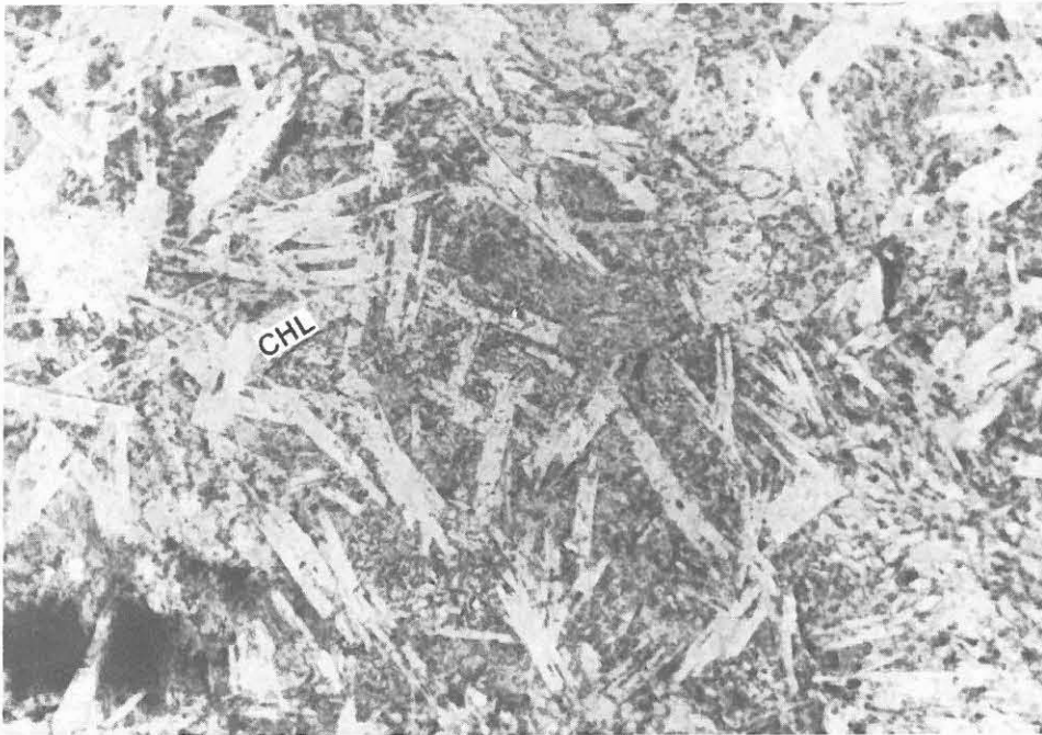
Abb. B.2.37: Sperrige Chlorite (CHL) in Meta-Ultramafitit (Schliff 288F4, 1382.57 m, 1 Nicol, 30-fach).
