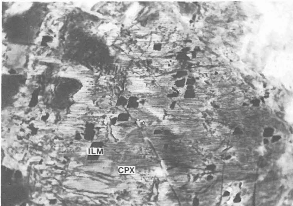
Abb. B.2.34: Braun durchschimmernde Ilmenit-Täfelchen (ILM) in farblosem, feinstlamelliertem Klinopyroxen (CPX) in Meta-Ultramafitit (Schliff 288C1qTI, 1380.71 m, 1 Nicol, 70-fach).
