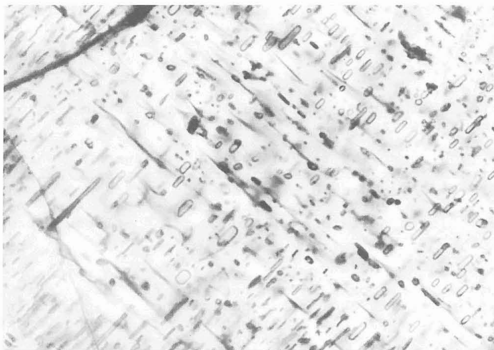
Abb. B.2.23: Parallel [010] (von untenlinks nach oben rechts) orientierte Rutilstengel in Klinopyroxen entmischt (Meta-gabbro) (Schliff 264H4nT, 1269.60 m, 1 Nicol, 630-fach).
