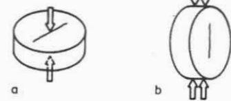
Abb. 5 a) Punktlastbruchversuch. Der entsprechende Makrobruch streicht in Richtung der vorhandenen Mikro-Entspannungsrisse. ( \sigma_{III} -Richtung) Abb. 5b) Brazil-Test zur Bestimmung der Zugbruchfestigkeit.
