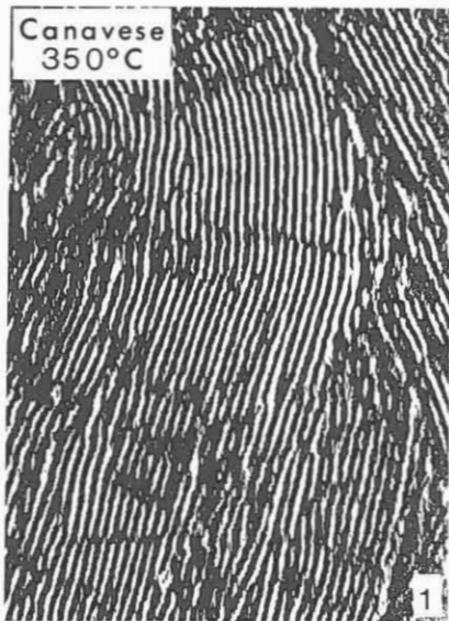
Fig. 1, 2, 3: (0002) Netzebenenabbildung (gefiltert), Pfeil markiert Stufenversetzung.
