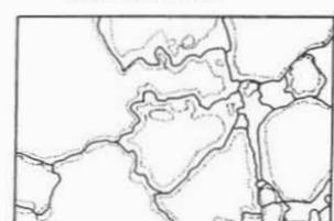
Abb. 6: Heterogener Sandstein (Key Lake, Kanada) mit Strahlenschäden entlang von Korngrenzen, verursacht durch pervasive radioaktive Lösungen. Bildbreite 1 mm
