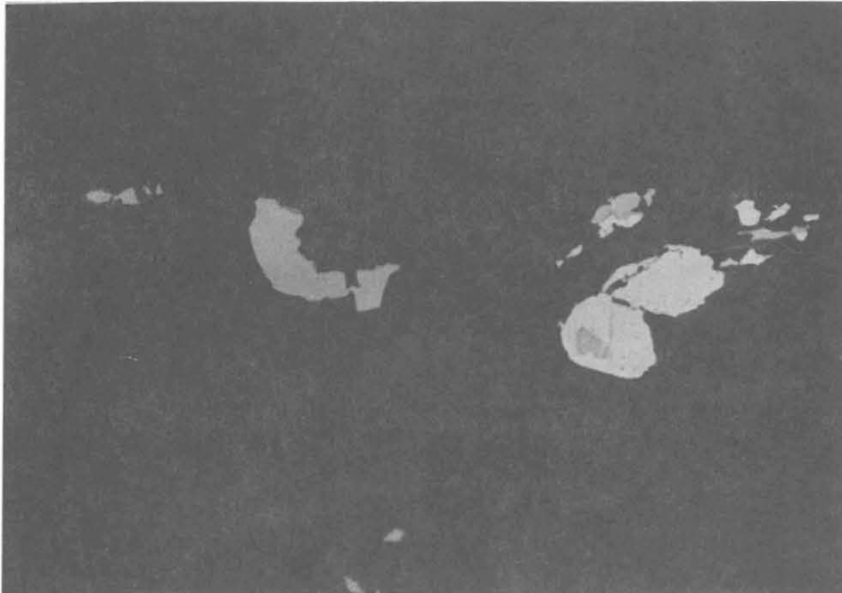
Abb. B.3.10: Pyrrhotin (mittelgrau) und Arsenopyrit (?) (hellgrau) mit Pyrrhotin-Einschluß in feinkörnigem, flaserigem Sillimanit-Biotit-Gneis. (Anschliff 536D1q, 2258.78 m, 240fach, 1 Nicol, Luft).
