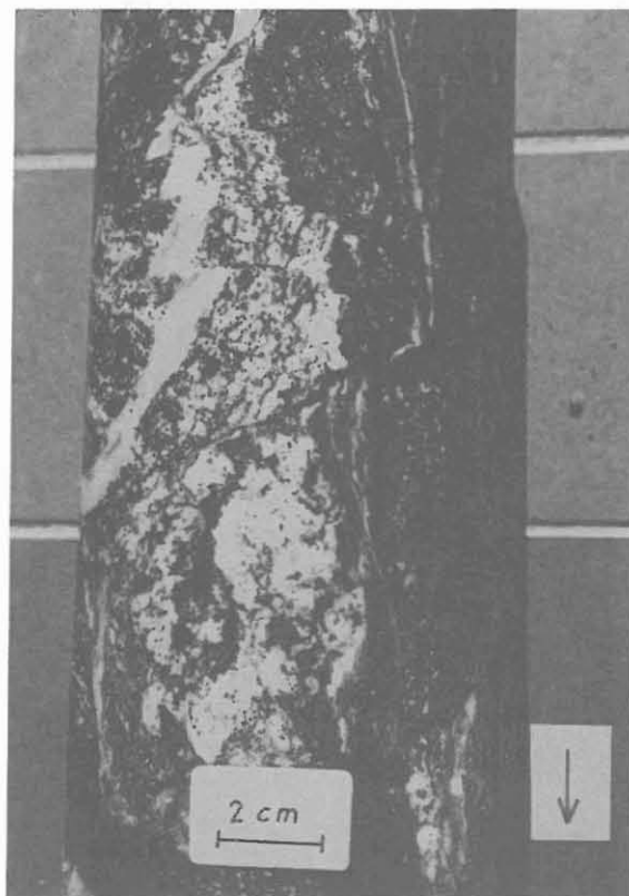
Abb. E.2.10: Kst. 275B1c, 1313,5 m 1) steiler, ca. 0,5 cm breiter Extensionsriss, kataklastisch überprägt. 2) relativ flache, aufschiebende Zone mit zugehörigen Riedel- Scherflächen, welche die weißen Gänge versetzen.
