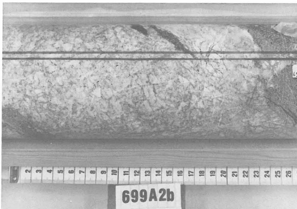
Abb. B.4.4: Gangförmiger Quarz-Plagioklas-Pegmatoid mit Kontakt zu Amphibolit (rechts), in der Mitte Biotit-Linsen. (Kernstück 699A2b, 2858.09 m).
