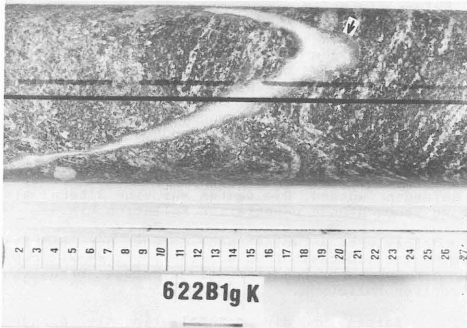
Abb. B.6.4: Kluft mit Epidot und Calcit mineralisiert; die grünen Epidote bilden das Salband (Pfeil). (Kernstück 622B1gK, 2563.19 m).
