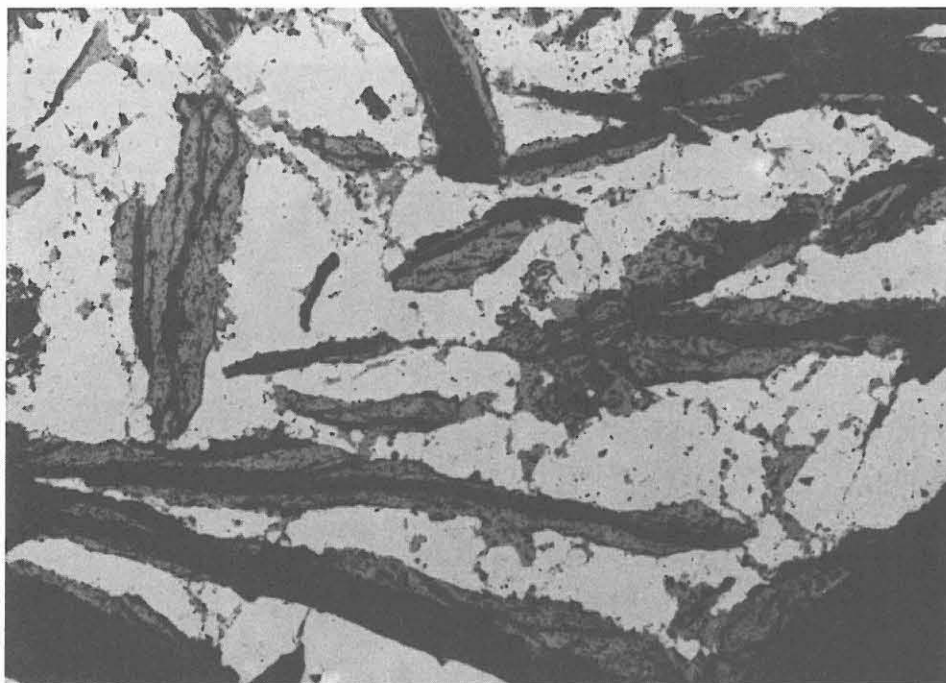
Abb. D.5.6: Anschliff aus dem oben (Abb. D.5.5) gekennzeichneten Bereich. Streifiger Magnetit (hellgrau) ist in Buchten und Hohlräumen von Pyrit (weißlich-grau) eingelagert (725B1jK; 2955.9 m; Luft, 1 Nicol, lange Bildkante: 3.6 mm).
