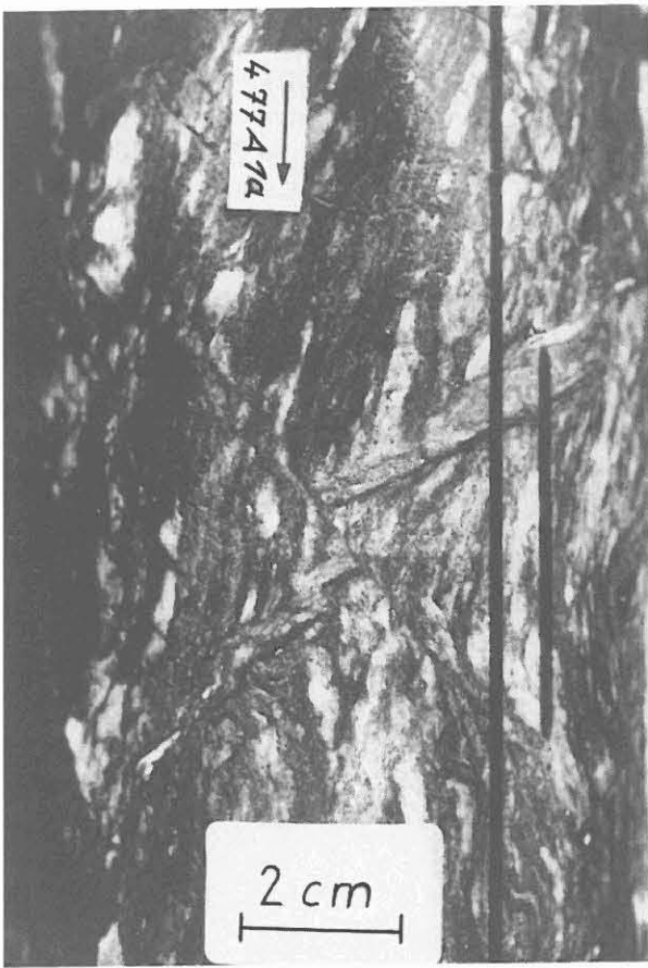
Abb. E.2.12: Eine ältere, graphitführende aufschiebende Kataklysezone wird entlang einer jüngeren diskreten Aufschiebung um 1 cm versetzt. Kst.-Nr. 477A1a, ca. 2086 m.
