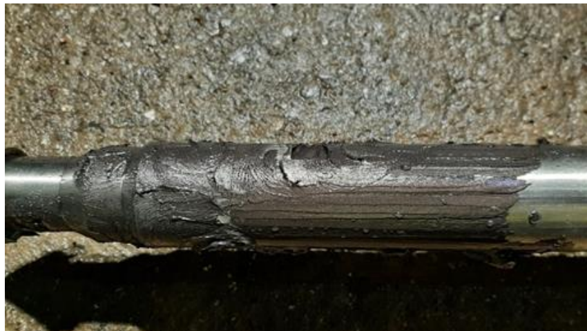
Abbildung 3: Die Messsonde war nach Sondenausfahrt aus der Bohrung Gt S7/20 zum Teil stark ölig verklebt
