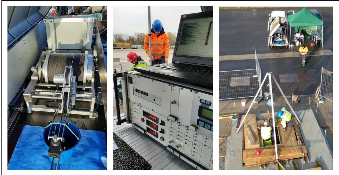
Abbildung 2: Winde (links), Messwerterfassung (mitte) und Messaufbau (rechts) während der Bohrlochmessung an der Bohrung Gt S7/20
