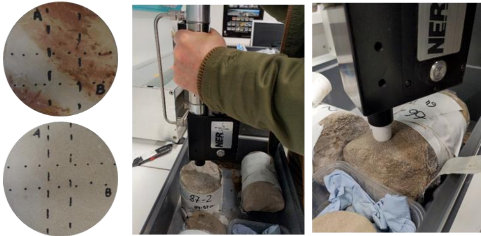
Abbildung 5: Markierungen für die Dokumentation der Messrichtungen bei der Bestimmung der thermischen Eigenschaften mit der TCS Apparatur (links) und Durchführung von TinyPerm-Messungen auf den Kernen (rechts)
