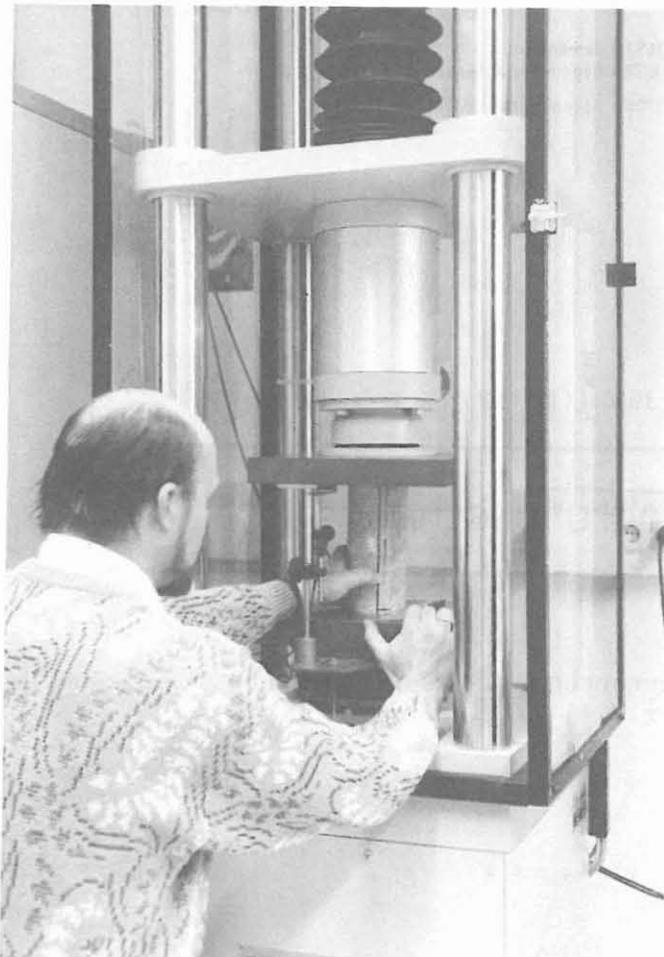
Abb. A.1.4: Universalprüfmaschine für felsmechanische Standarduntersuchungen (oben: Gesamtübersicht; unten: Einsetzen des Testkörpers)
