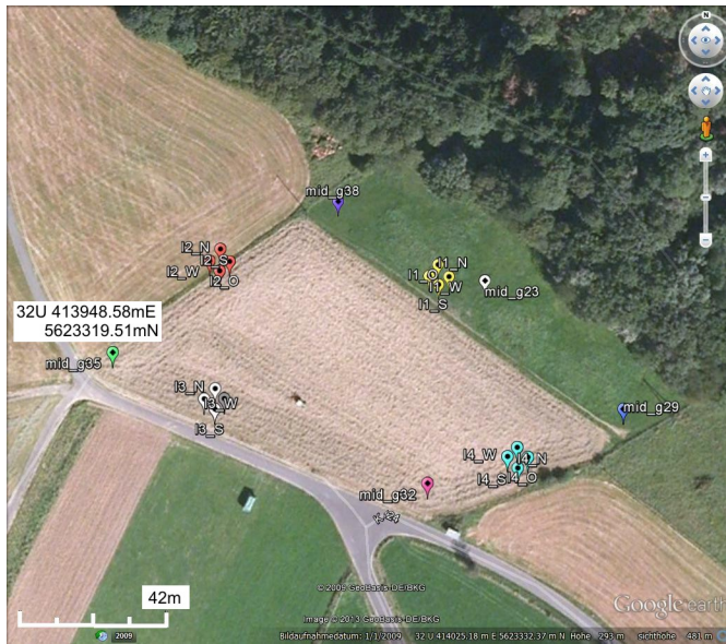
Abbildung 6: Stationsaufbau der Bipol-Quadrupol Testmessung im Mai 2013. Die einzelnen Markierung mid\_gxy zeigen die Position der Spannungsbipol-Mittelpunkte. Die Markierungen I1 bis I4 zeigen die Lage der Elektroden zur Stromeinspeisung.
