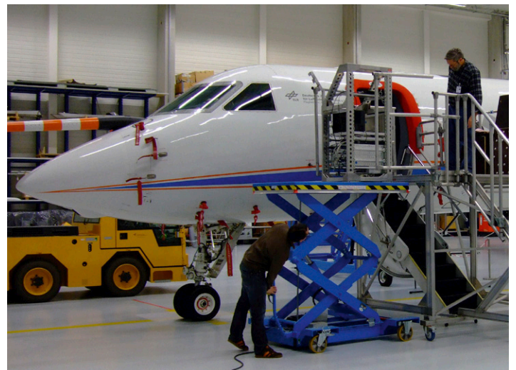
Einbau eines teilbestückten Baugruppenträgers in das HALO-Flugzeug während der Stellprobe
