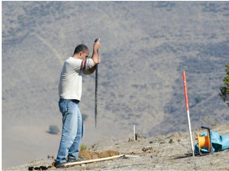
Der GFZ-Mitarbeiter Naser Meqbel bei der Vorbereitung einer Geräteinstallation. Magnetische Sensoren müssen vergraben werden, um Temperatur- und Windeffekte zum vermeiden.
