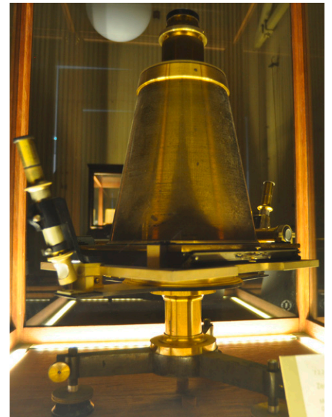
Die Zentih-Camera von Max Fechner aus dem Jahr 1900. Fotos des Himmelzenits wurden mit einer Himmelskarte zur genauen geografischen Ortsbestimmung von Messpunkten verglichen.
