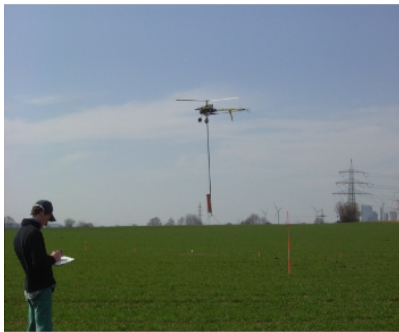
Abbildung 1: UAS - Magnetfeldmessungen bei Köln
