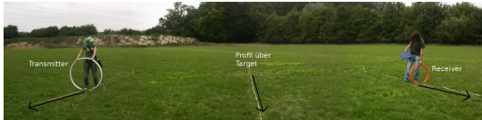
Abbildung 9: Messanordnung der EM34-Messungen im Horizontal-Dipol-Modus
