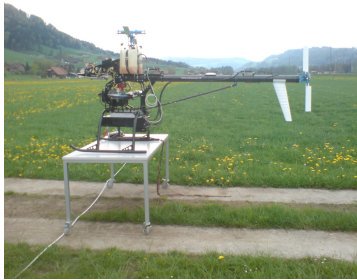
Abbildung 5: Aufbau des Hubschraubers bei der Noisemessung in Luzern ohne Logger und Sensor.
