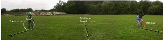
Abbildung 9: Messanordnung der EM34-Messungen im Horizontal-Dipol-Modus
