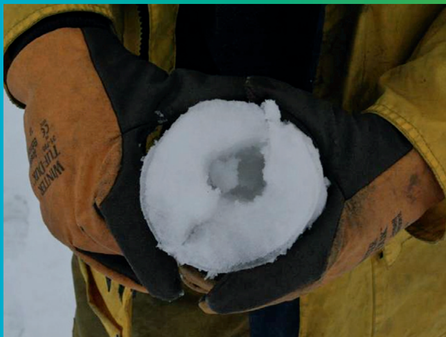
Abb. 1: Nassschneeablagerungen an Freileitungen im westlichen Münsterland am 25. und 26. November 2005 (Foto aus Kießling und Wichura, 2009)
