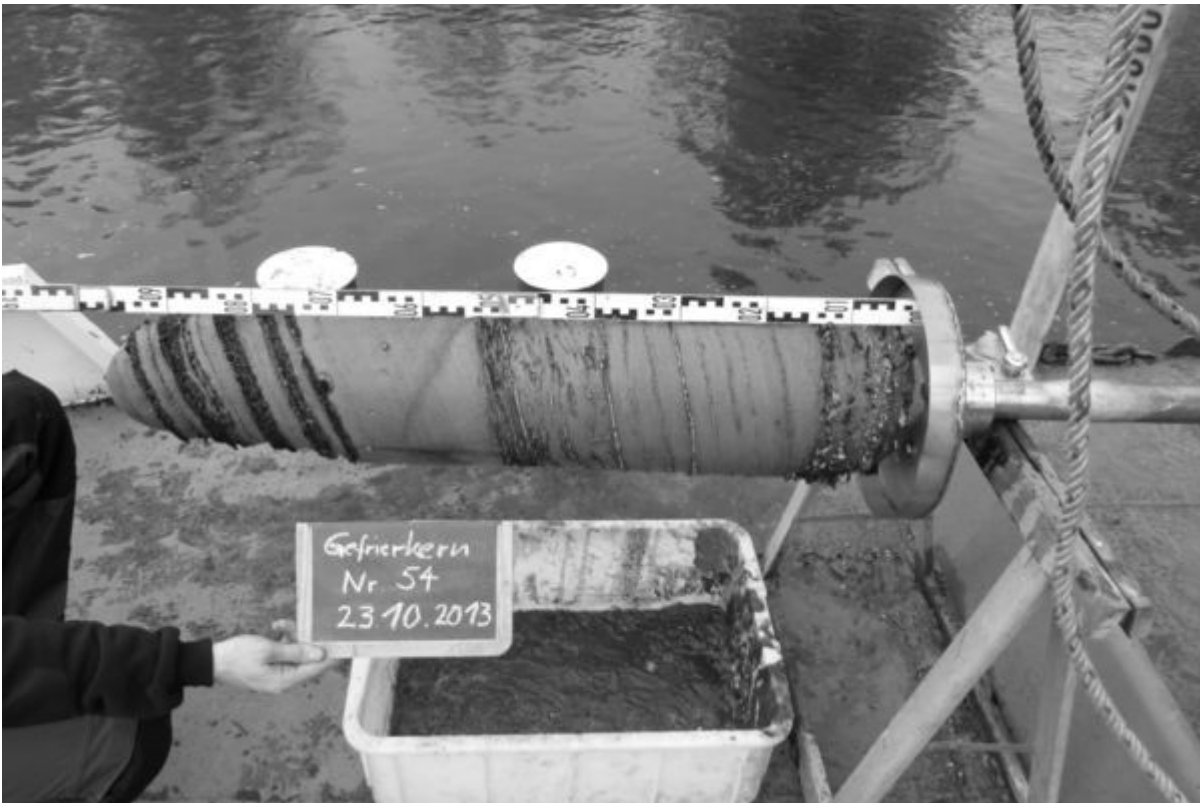
aus der Sohle des Sacrow-Paretzer Kanals entnommener Gefrierkern
