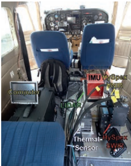
Abb. 2: Abbildende Spektrometersysteme (GFZ-HySpex, Zeilenscanner) im Flugbetrieb, hier in Zusammenarbeit mit der MILAN Geoservice GmbH, mit einem Laserscanner (LIDAR) zur Aufnahme des Geländes. Zusätzlich wird eine Thermalkamera eingesetzt. Rechts: Sensoren auf der Flugzeugunterseite (Fotos: M. Brell, GFZ)
