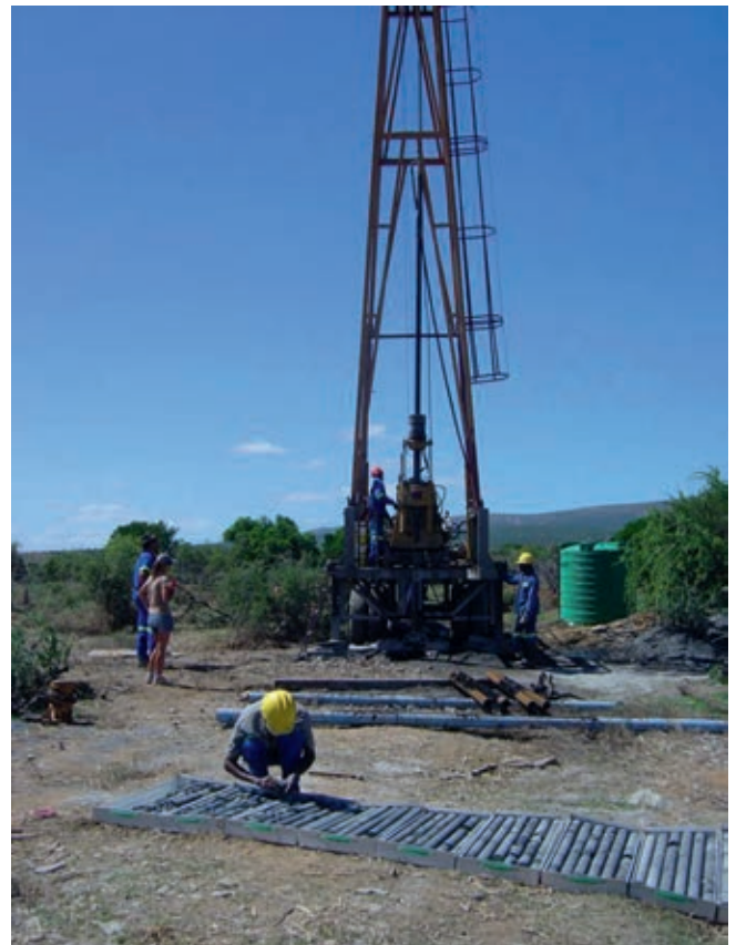
Abb. 1: Inkaba-Bohrung im Karoo-Becken in 2012. Im Vordergrund: bereits erbohrte dunkle Tonsteine der Eccca-Gruppe (Foto: H.-M. Schulz, GFZ)
