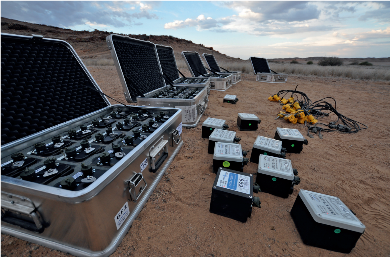
Abb. 2: Vorbereitung von 300 seismischen Rekordern für Untersuchungen von Erdkruste und oberem Mantel am Kontinentalrand Namibias (Januar 2012). Die Geräte wurden sukzessive an 2000 Messpunkten entlang eines 200 km langen Profils aufgebaut. (Foto: Ch. Haberland, GFZ)
