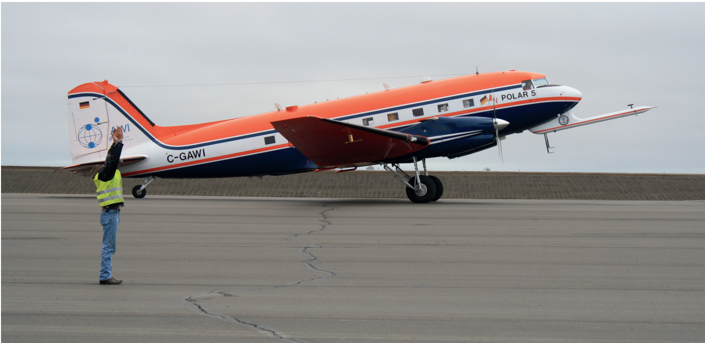
Die Basler BT67 „Polar5“ mit Nasenmast während der AIRMETH-Kampagne (Foto: T. Sachs, GFZ)
