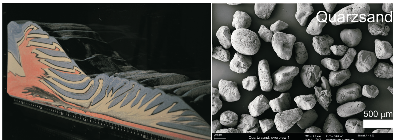
Abb. 1: Links: Abbildung eines labormaßstäblichen Gebirges, entstanden durch Verkürzung ursprünglich horizontaler Sandschichten (von unten nach oben: rot-weiss-blau); rechts: Rasterelektronenmikroskopische Aufnahme von Quarzsand, wie er in der Analogmodellierung von Gebirgen Verwendung findet (Fotos: M. Rosenau, H. Kennitz, GFZ)
