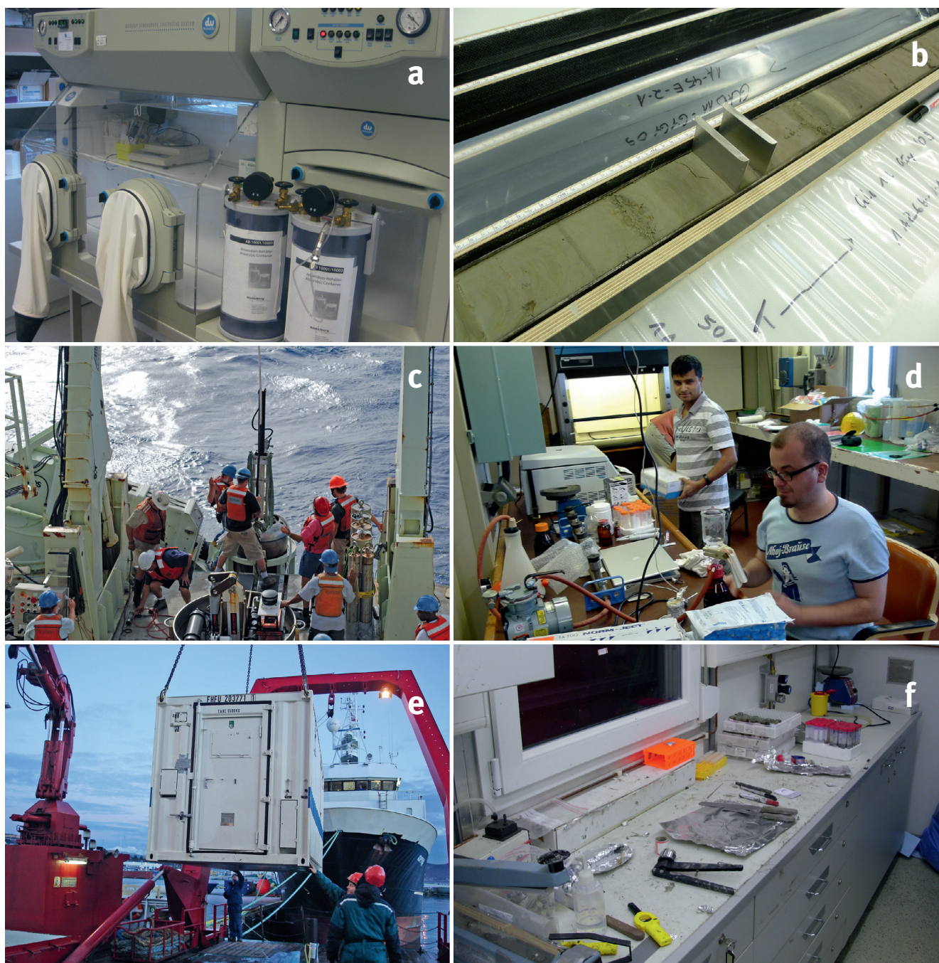
Abb. 1: Methodischer Einblick in die Arbeit der Geomikrobiologen: a) Arbeiten in der Handschuhbox (Glovebox) – ein gasdicht abgeschlossener Behälter für das Arbeiten unter einer definierten z. B. sauerstofffreien Atmosphäre und zwei Anaerobieröpfe rechts vor der Glovebox dienen der Kultivierung von Mikroorganismen unter sauerstofffreien Bedingungen (Foto: J. Görsch, GFZ), b) Öffnen und Beprobieren eines Sedimentkerns nach definiertem Beprobungsschema (Foto: J. Görsch, GFZ), c) und d) wissenschaftliches Arbeiten auf einem Forschungsschiff (Fotos: J. Kallmeyer und C. Glombitza, GFZ), e) das mobile Geomikrobiologie-Labor „BugLab“ beim Abladen von einem Forschungsschiff (Foto: K. Mangelsdorf, GFZ) und f) Arbeiten im „BugLab“ während einer Expedition (Foto: C. Glombitza, GFZ)
