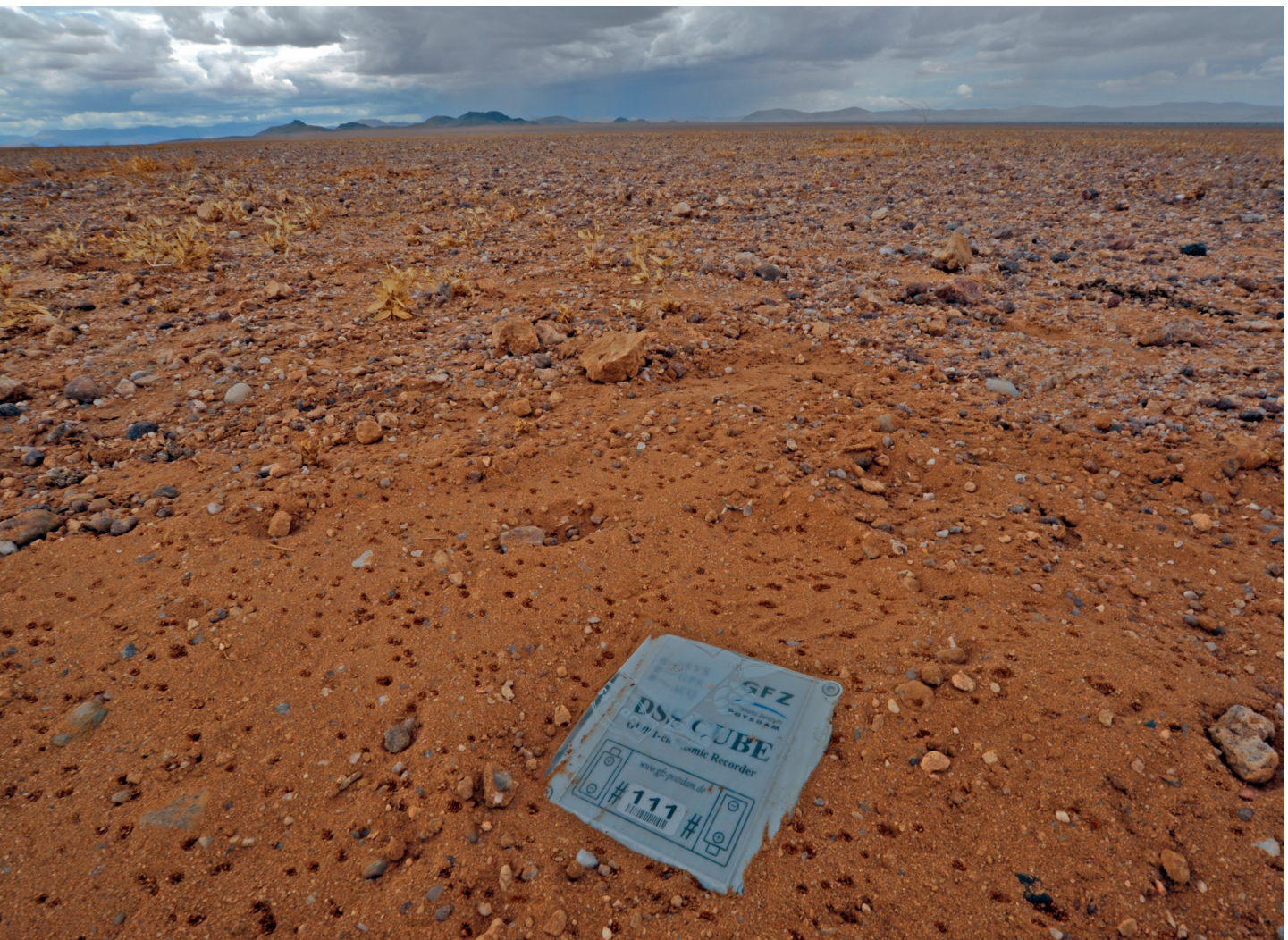
Abb. 3: Die Registrierstationen – wie hier in der namibischen Wüste – können fast vollständig eingegraben werden, um beispielsweise Störungen durch Tiere zu minimieren. (Foto: Ch. Haberland, GFZ)
