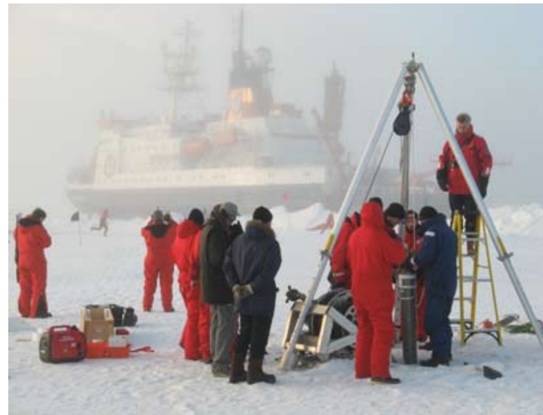
Abb. 1: Ausbringen einer autonomen Messboje zur täglichen Erfassung von Meerwassereigenschaften bis in 800 m Tiefe (Foto K. Bakker). Die Boje driftet bis zu 3 Jahre mit der Eisscholle. Im Hintergrund der Eisbrecher Polarstern.
