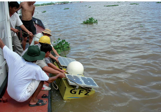
Die Bojen zur Wasserstandsmessung sind eine Weiterentwicklung aus dem Tsunami-Frühwarnsystem GITEWS.
