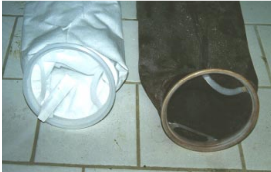
Abbildung 7-8: Filter vor und nach der Slopwasserverpressung
