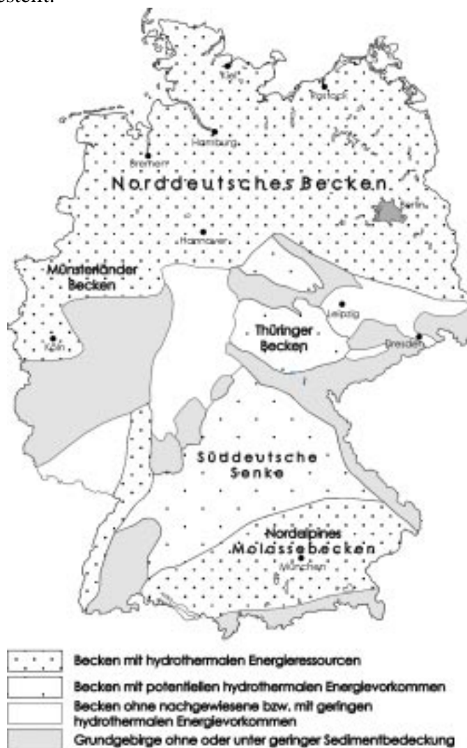
Abb. 3-1: Gebiete vergleichbarer geologischer Bedingungen im Hinblick auf eine hydrothermale Nutzung [Hoth et al., 1997]
