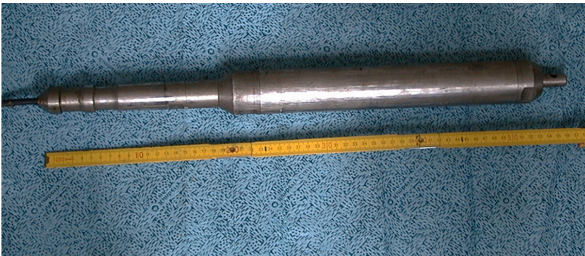
Abb. 14: Kabelendstück des 700 m DTS-Meßkabels.
