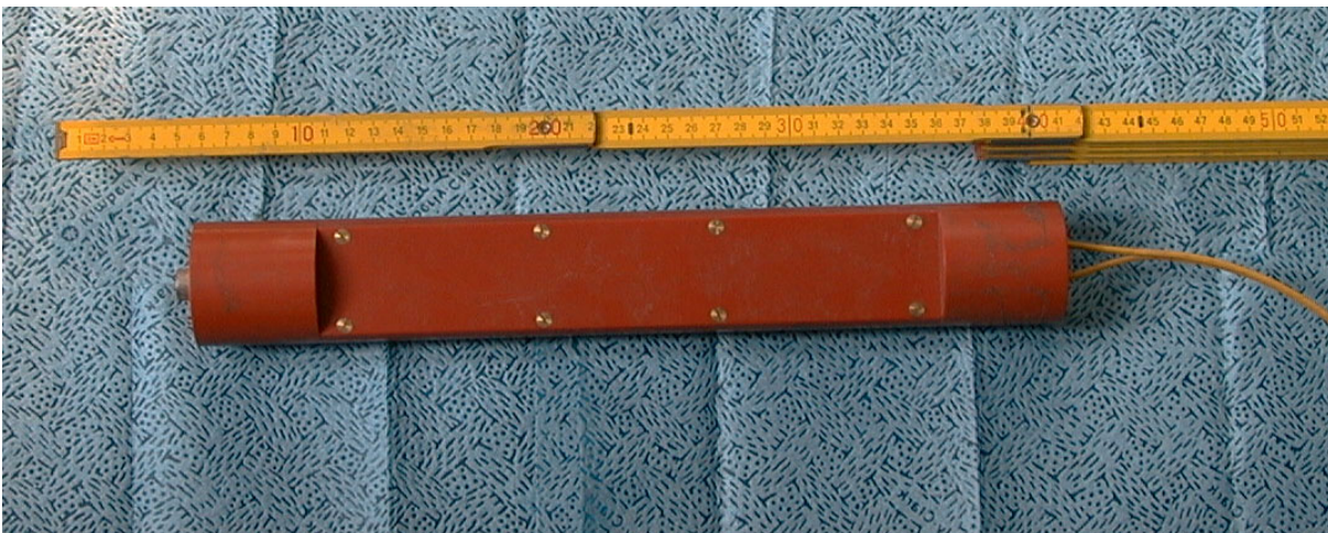
Abb. 29: Kabelendstück des 2000 m DTS-Meßkabels.
