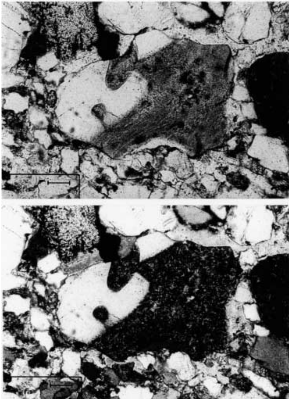
Abb. 10.38: Rhyolithgeröl mit gebuchtetem ( embayed ) Quarzeinsprengling (Bohrung Stavenhagen 1/76 bei KM 4805,7; unten gekreuzte Nicols). Skala beträgt 100 \mu\text{m} .
