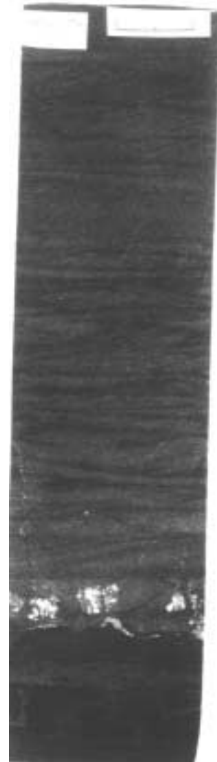
Abb. 10.10: Lithotyp Sf, r aus der Bohrung Stavenhagen 1/76 bei KM 4650,3 ( Mirow-Formation). Über feinsandigen Tonsiltsteinen mit Trockenrissen an der Basis setzt der hier gut sortierte Feinsandstein mit kleinskaliger Flaser- und Rippelschichtung und Anhydrit-Konkretionen ein. Am Top sind deutlich kleinskalige Schrägschichtungssets zu erkennen.
