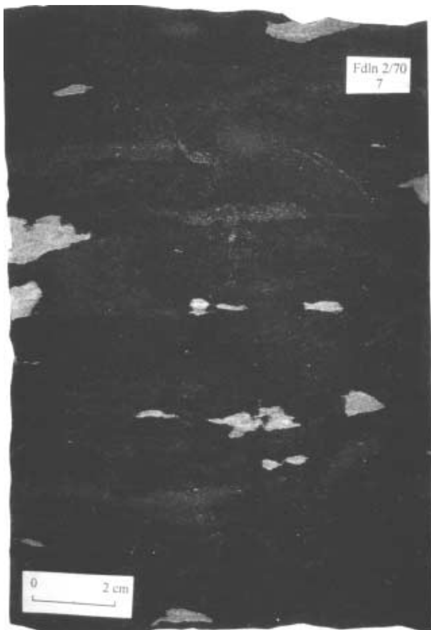
Abb. 10.17: Lithotyp Sf(M), I aus der Bohrung Friedland 2/70 (bei KM 3675,8). Schön zu sehen sind an diesem Beispiel die weißen Anhydrit-Konkretionen.
