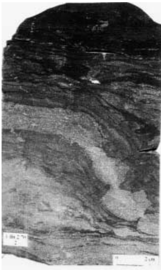
Abb. 10.24: Lithotyp Sc(M), I aus der Bohrung Friedland 2/70 (KM 3523,3). Soft-sediment Deformation einer dünnen schlecht sortierten Feinsandsteinlage.
