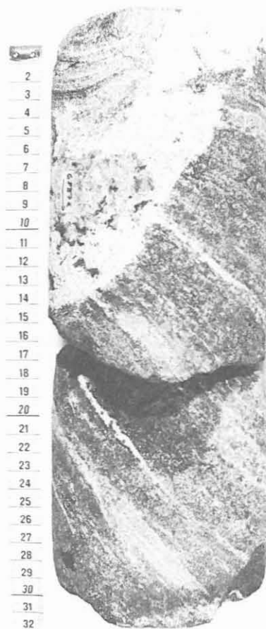
Abb. 6: Abwicklung (a) und Makroaufnahme (b) der Kernstücke 68B7a,b: diskordanter Kontakt zwischen Granat-Biotit-Gneis (rechts unten im Bild) zu Amphibolit mit Kalksilikat-Bändchen, getrennt durch helles Mobilisatband mit Biotitflasern
