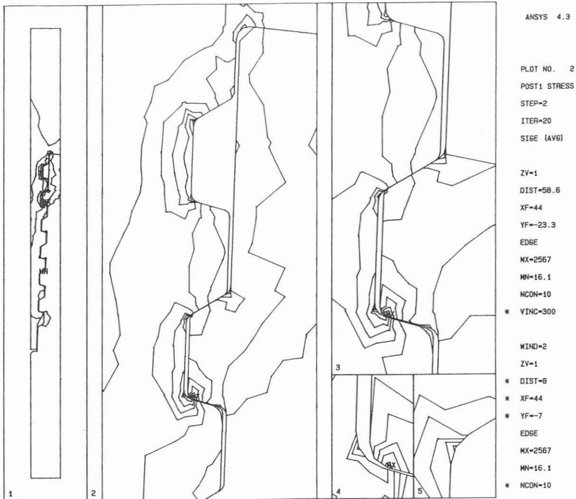
Abb. 10: Beispiel eines FEM-Plots von Spannungskonzentrationen im Gewinde
