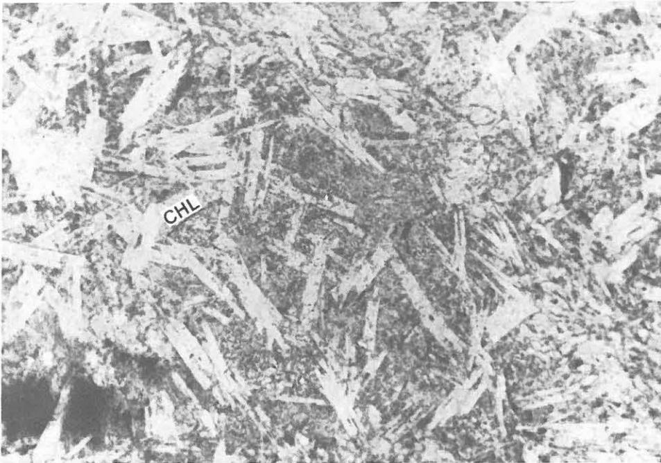
Abb. B.2.37: Sperrige Chlorite (CHL) in Meta-Ultramafitit
