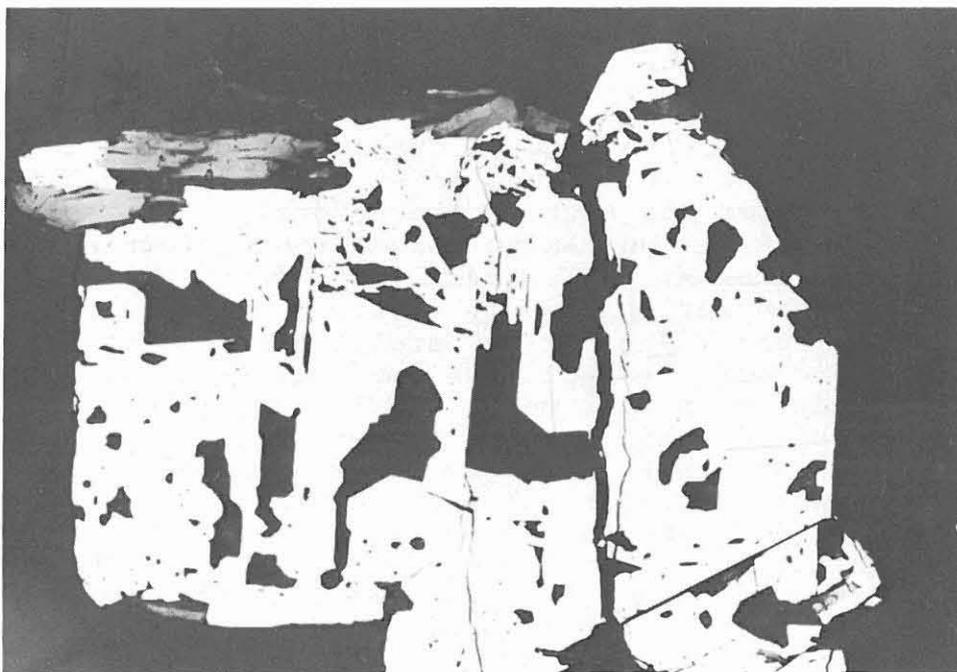
Abb. B.2.6: Hypidiomorphes Pyritaggregat; Risse und Hohlräume zeigen eine bevorzugte Orientierung; Graphitleisten als An- und Einlagerung (Anschliff CUT1034ERZ, 1034 m, Körnerpräparat, 1 Nicol, 125-fach, Luft).
