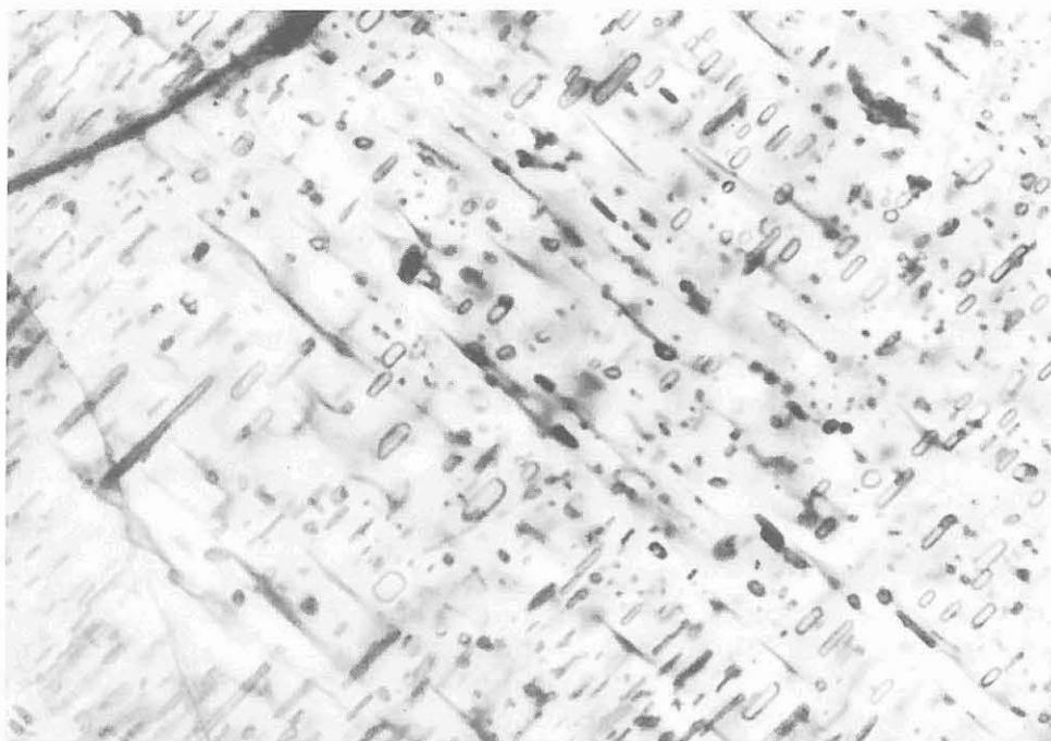
Abb. B.2.23: Parallel [010] (von untenlinks nach oben rechts) orientierte Rutilstengel in Klinopyroxen entmischt (Meta-gabbro)
